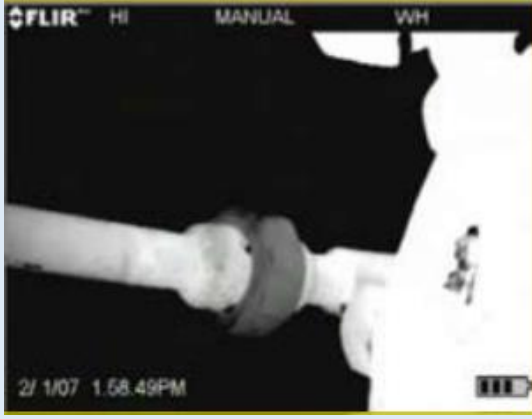
شكل 11: مرئية بالأشعة تحت الحمراء قبل تطبيق التنغيم الحراري (يمين) وبعد تطبيقه (يسار)
