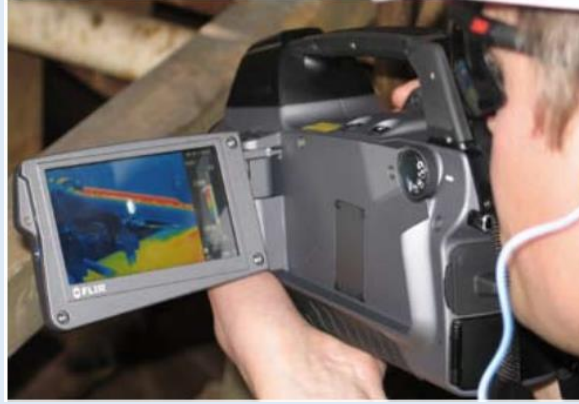
شكل 15: كاميرا الأشعة تحت الحمراء لرصد التسرب الغازي
