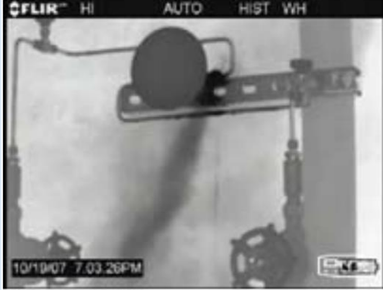
شكل 1: مرئية بالأشعة تحت الحمراء المتوسطة لغاز متسرب من قياس الضغط
