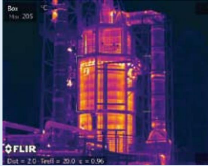
شكل 3: مرئية بالأشعة تحت الحمراء المتوسطة للانبعاث الحراري من فرن معالجة بتروكيماوي
