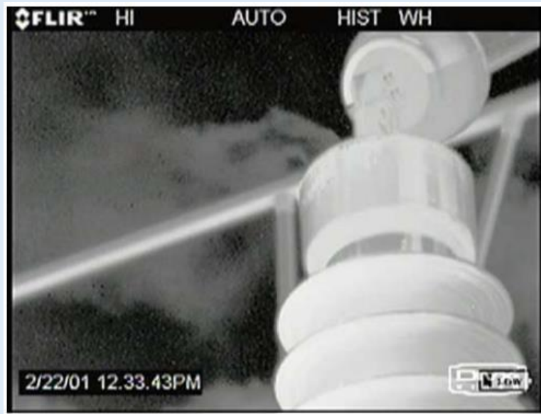
شكل 2: مرئية بالأشعة تحت الحمراء البعيدة لتسرب سداسي الفلور الكبريتي من عازل الجهد العالي
