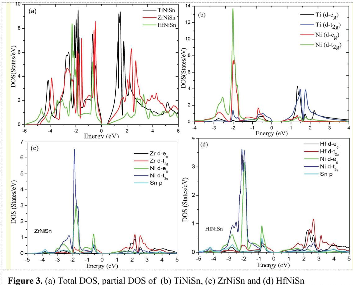
**Figure 3.** (a) Total DOS, partial DOS of (b) TiNiSn, (c) ZrNiSn and (d) HfNiSn
