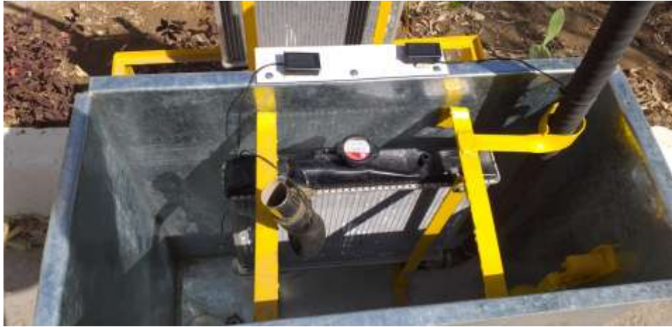
شكل (4) المشع مغمور بالماء داخل الخزان
