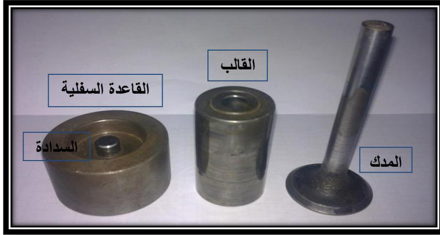
الشكل (5.3) أجزاء القالب المستخدم في عملية الكبس.
