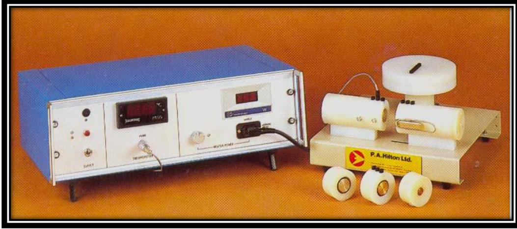
الشكل (10.3) جهاز قياس الموصلية الحرارية
