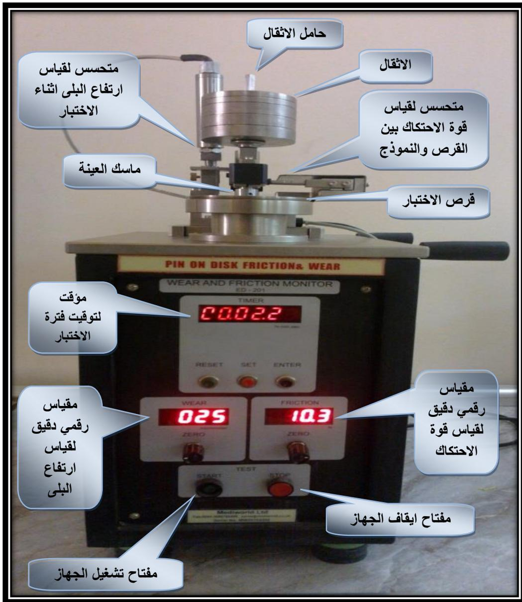
الشكل (8.3) جهاز قياس البلى وقوة الاحتكاك
