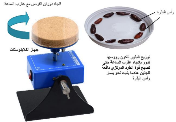
شكل (7): جهاز الكلاينوستات و توزيع البذور في الطبق
