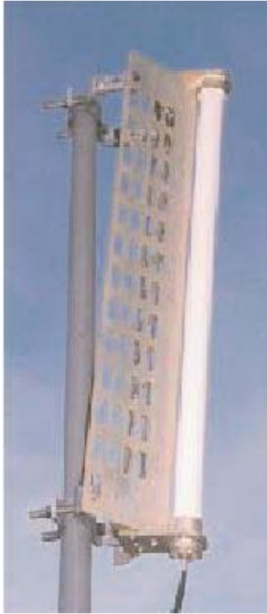
شكل 5: هوائي قطاعي Sectoral Antenna (A2.45LP14 180°)
