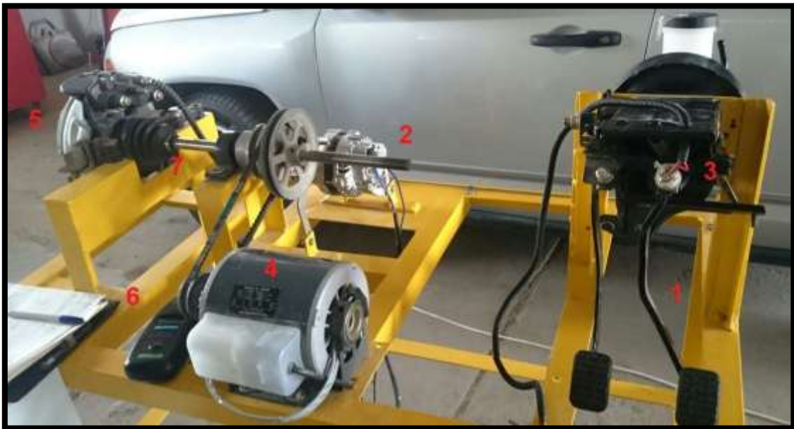
1- دواسة الموقف 2- مولد التيار الكهربائي 3- مفتاح مصباح الموقف الخلفي 4- محرك كهربائي 5- موقف قرصي مع مخدات التوقيف 6- جهاز قياس سرعة دوران عمود الادارة (تاكوميتر)
