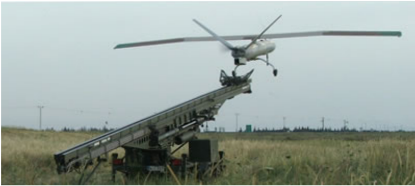
شكل (٥٤) الطائرة هيرمس تطلق من قاذف الإطلاق نوع Robonic.
