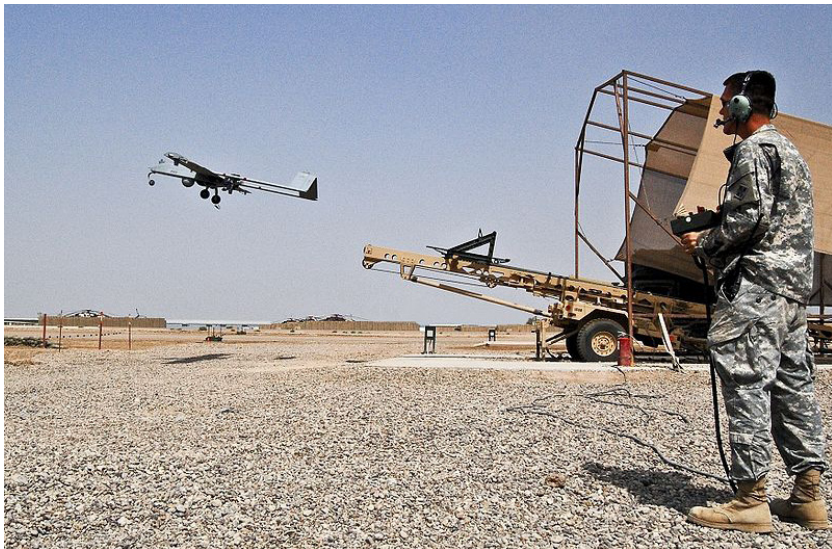
شكل رقم(4٥) الطائرة نوع RQ-7Bتغادر قاذف الإطلاق
