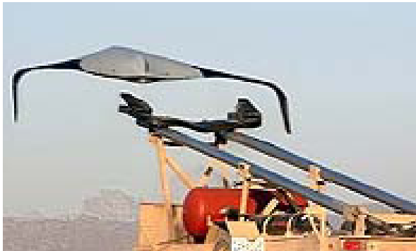
شكل رقم (47) الطائرة Killer Bee تنطلق من قاذف الإطلاق الهوائي
