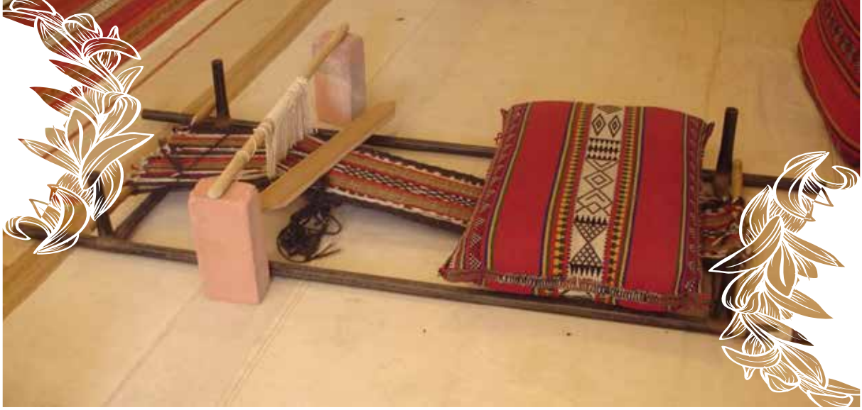
الشكل (5): تثبيت نول السدو المعدني بجلوس الناسجة على مسند(مخدة) توضع على الامتداد المعدني الأمامي للنول أو على الجزء المنسوج منه
