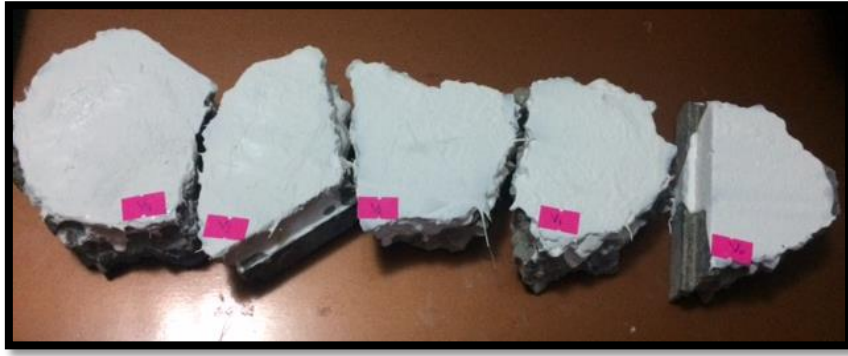
الشكل (٧) العينات المحضرة من المادة الاساس والالياف لاجراء فحص الالتصاقية
