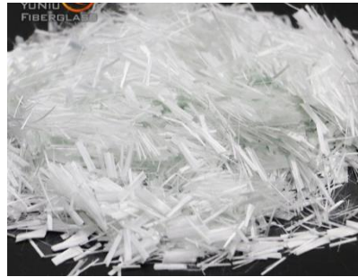
صورة رقم (٢) الياف الزجاج المقطعه صورة رقم (٣) مادة الطلاء على سطح المنزل
