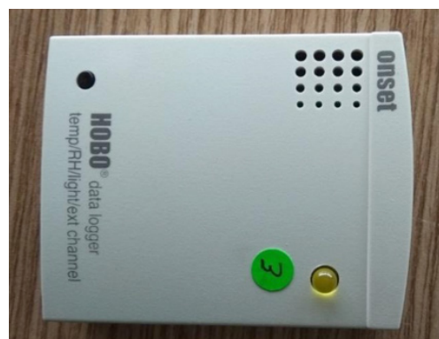
RAJAH 3. Instrumen HOB0® U12 dengan pengeloc data untuk pengukuran suhu, kelembapan relatif dan pencahayaan
