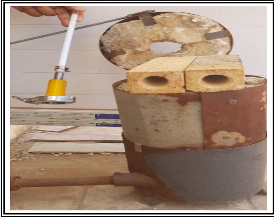
الشكل (2-3) الفرن المستعمل لتحضير السبيكة واداة تدوير انبوبة الكوارتز
