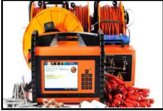
شكل (6) جهاز قياس الكهربية Terrameter LS.
