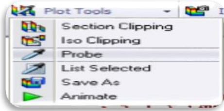
الشكل (11) استخدام أمر Probe
