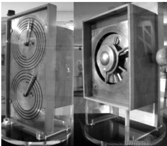
Рисунок 5. – Работающая копия устройства, моделирующая движение Солнца и Луны относительно звезд
