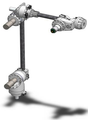
Rys. 1. Trójwymiarowy model nowego manipulatora łazika Kalman
