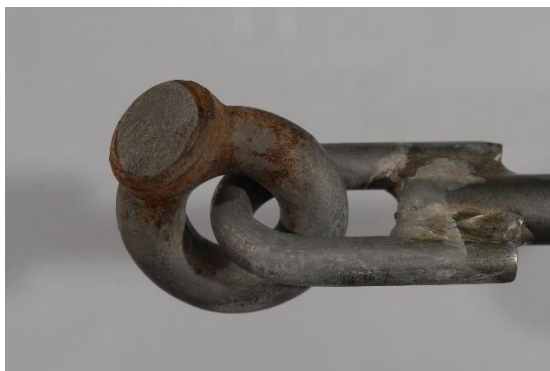
Rys. 1. Uszkodzone „oczko” cięgła bocznego ciągnika Ursus C-360 3p
