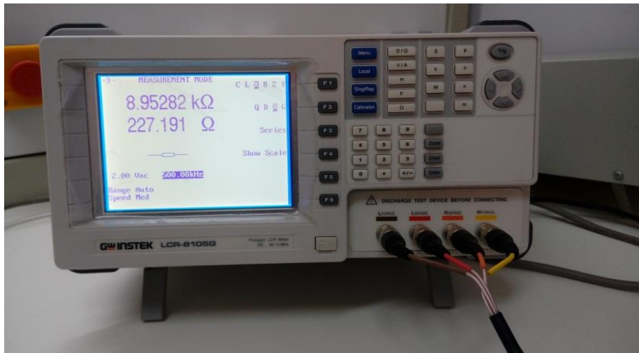
Fig. 4. Les valeurs de la réactance et de la résistance dans LCR-mètre.
