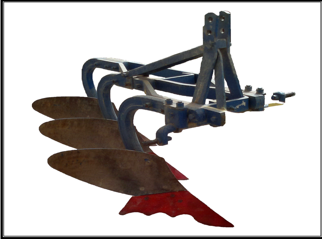
الملحق (٨) صورة للمحراث المطرحي القلب بالسكة المقطعة
